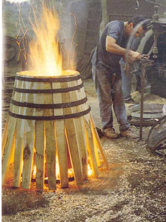
Fig. 2. Immagine del processo di tostatura della barrique .
